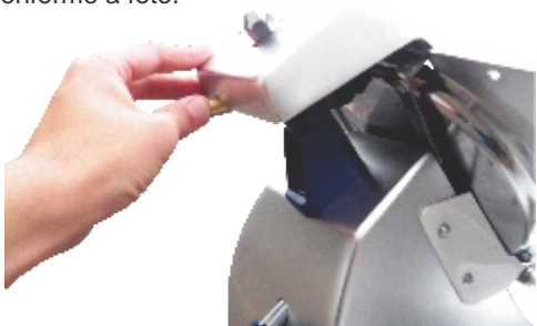
5 - Ligue a máquina e pressione o botão da pedra de afiar do afiador fixo por 1 minuto.
