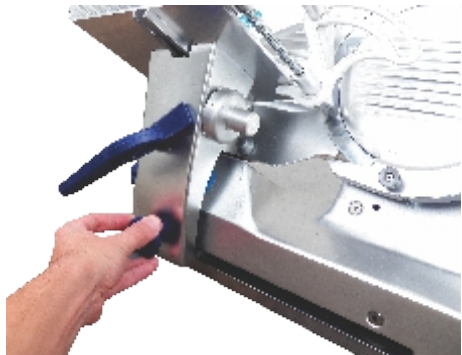
1 - Desligue a máquina e remova o carro porta frios, retirando o manípulo do cabeçal.
