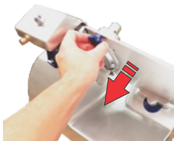
6 - Para finalizar puxe a mesa suavemente através do manípulo do afiador removível por 15 segundos no sentido da flecha indicativa, fazendo com que a pedra de afiar retire as rebarbas. Conclua a operação, desligue a máquina, feche o regulador de corte e coloque o afiador removível na posição inicial.
